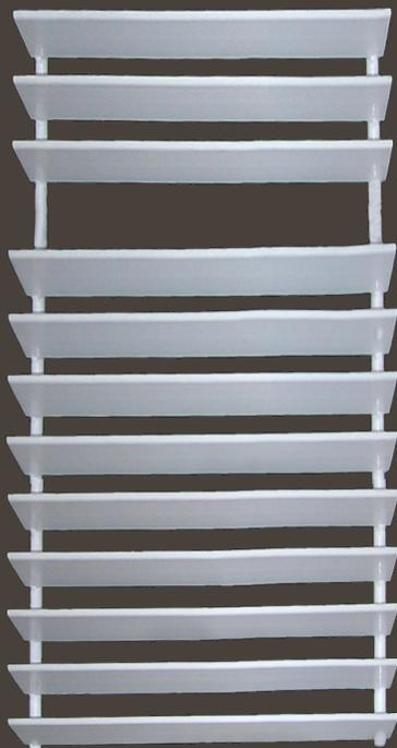
Il termoarredo Geber **VELA 70 OR** è prodotto con profili ovali di profondità 70 mm disposti orizzontalmente a taglio e saldati con passo costante su collettori verticali tondi di diametro 35 mm.
