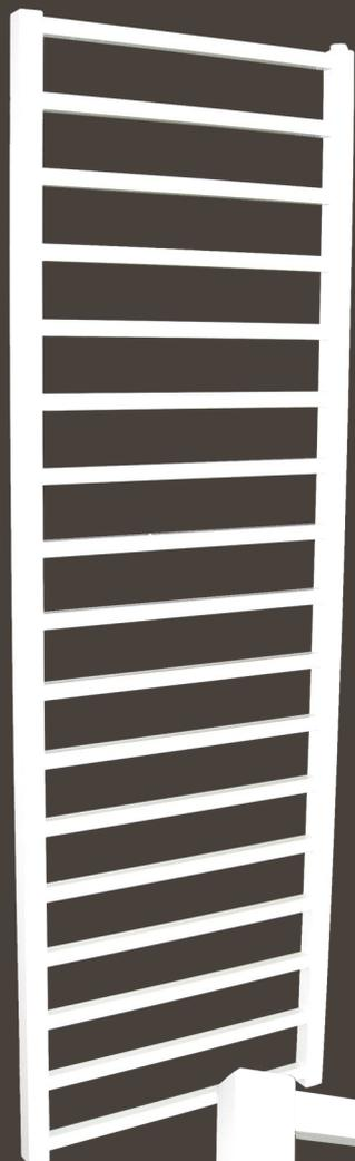
Il termoarredo Geber **RETTANGOLO** è prodotto con profili quadrati in acciaio 20 x 20 mm disposti orizzontalmente, distanziati con passo costante e saldati su collettori verticali quadrati 30 x 30 mm.
