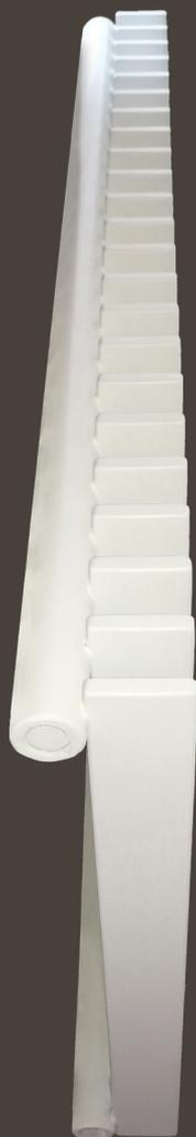
Il termoarredo Geber **VELA 50 S** è prodotto con profili rettangolari di sezione 50 x 10 mm, disposti verticalmente con passo costante e saldati su collettori orizzontali tondi di diametro 35 mm.
