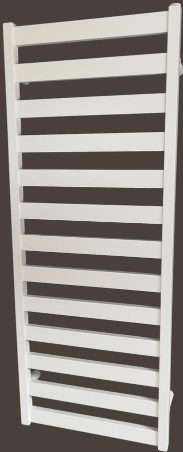
Lo scaldasalviette Geber **RETTANGOLO 50** è prodotto con profili rettangolari in acciaio 50 x 20 mm disposti orizzontalmente, distanziati con passo costante e saldati su collettori verticali quadrati 30 x 30 mm.
