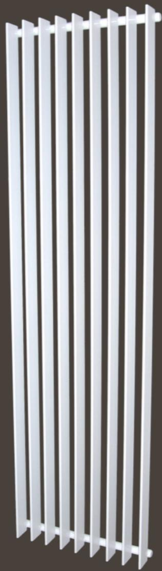
Il termoarredo Geber **VELA 70 S** è prodotto con profili ovali di profondità 70 mm disposti verticalmente a taglio con passo costante e saldati su collettori orizzontali tondi di diametro 35 mm.
