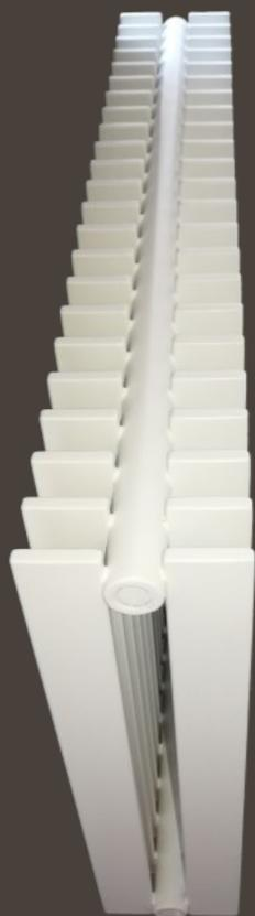
Il termoarredo Geber **VELA 50 D** è prodotto con profili rettangolari 50 x 10 mm disposti verticalmente a doppio rango e saldati con passo costante su collettori orizzontali tondi di diametro 35 mm.
