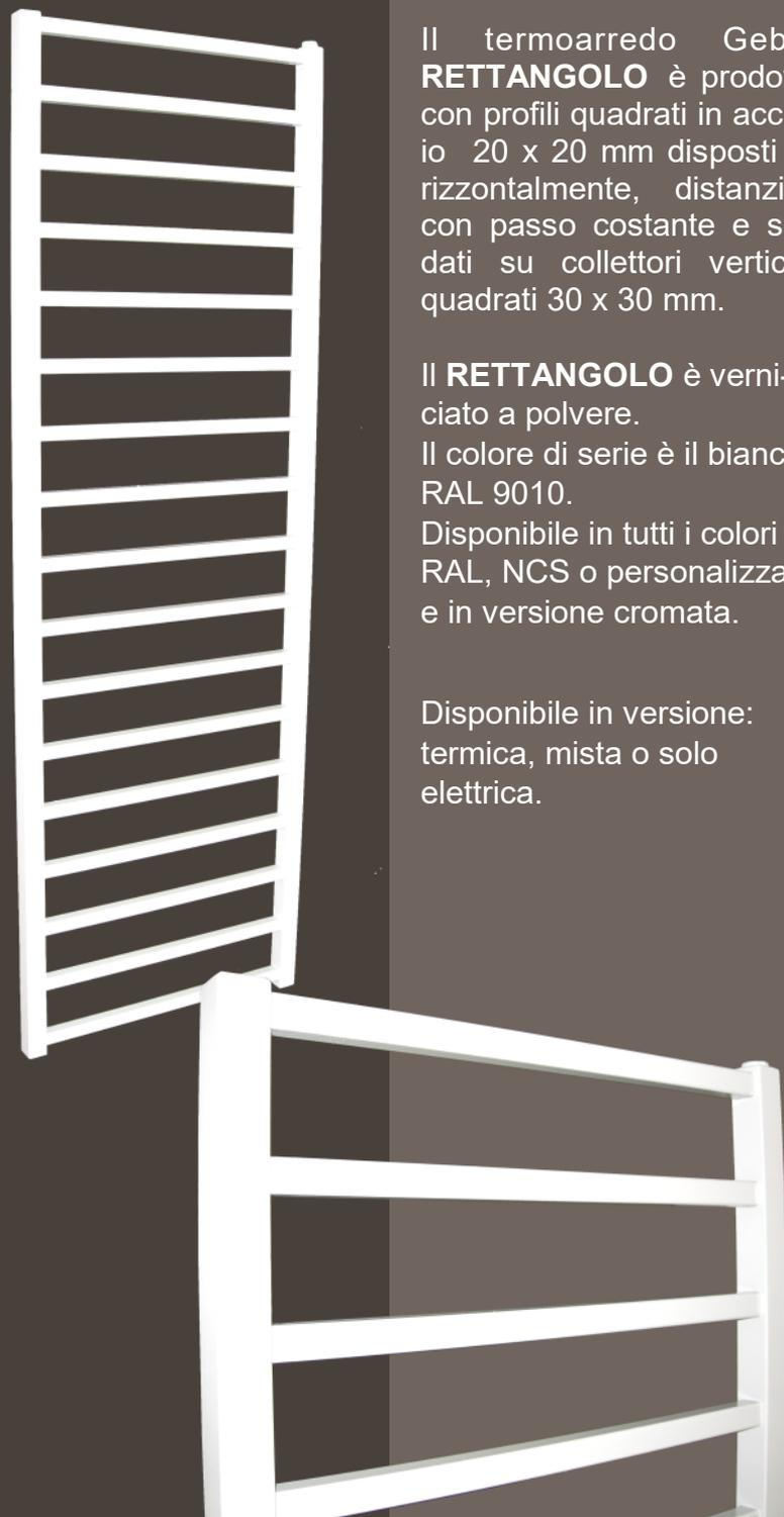
Il termoarredo Geber **RETTANGOLO** è prodotto con profili quadrati in acciaio 20 x 20 mm disposti orizzontalmente, distanziati con passo costante e saldati su collettori verticali quadrati 30 x 30 mm.
