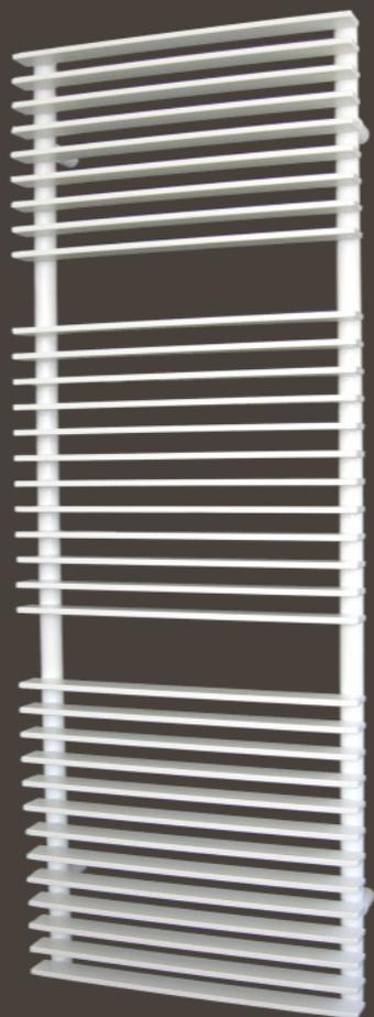
Lo scaldasalviette Geber **VELA 50 OR** è prodotto con profili rettangolari di sezione 50 x 10 mm, disposti orizzontalmente e saldati con passo costante su collettori verticali tondi di diametro 35 mm.
