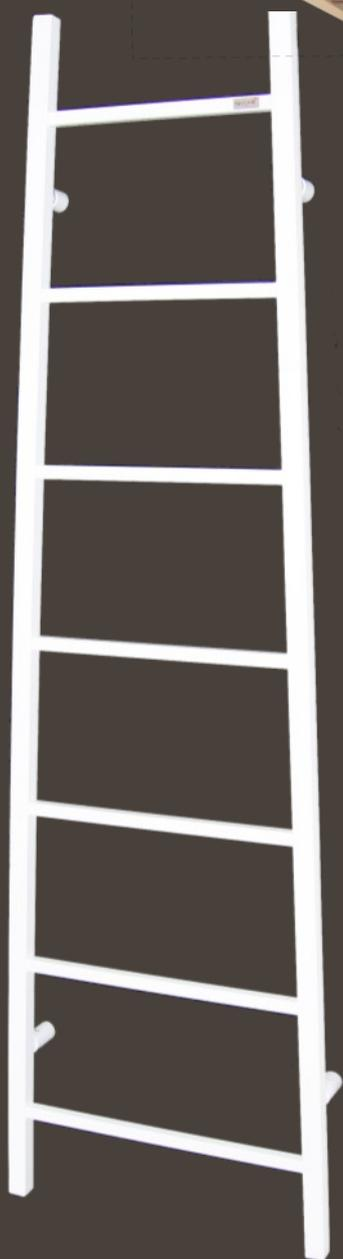
Il termoarredo Geber **SCALINO** è prodotto con profili quadrati in acciaio 20 x 20 mm disposti orizzontalmente e saldati su collettori inclinati 30 x 30 mm.
