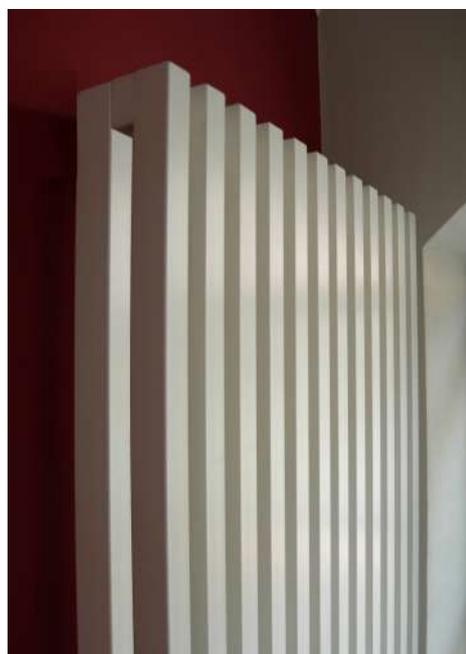
**LUCE A D** è fabbricato con profili rettangolari 50 x 40 mm in acciaio disposti a doppio rango. Disponibile in versione *idrica, mista o solo elettrica*. La verniciatura è a polvere: colore standard RAL 9010 lucido. Disponibile in tutti i colori RAL, NCS e personalizzati.
